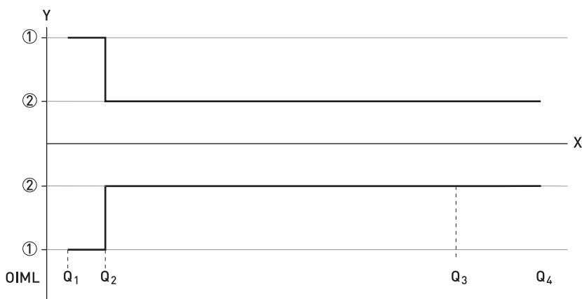
Рисунок 6-2: Расходы согласно стандарту международной организации по стандартизации (ISO) добавлены к рисунку для сравнения с директивой по измерительному оборудованию (MID)
